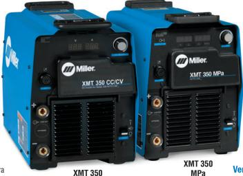
Tecnología Auto-Line™ de gestión de tensión que permite conectar a cualquier voltaje (230–575 V) sin necesidad de conexión manual, ajustándose a cada ubicación de trabajo. Es la solución ideal para tensiones de entrada no fiables o sucias.
