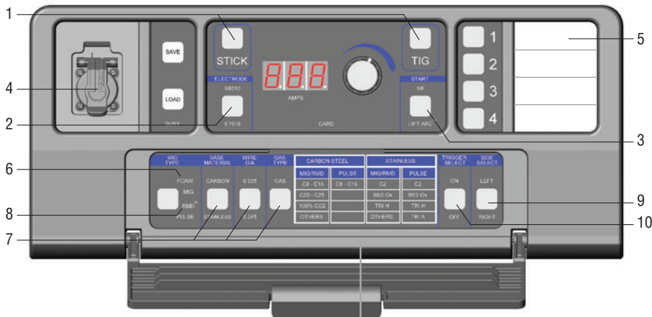
Panel de Control de la Fuente de Poder PipeWorx con la Puerta Abierta
