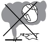
Mantenga la cabeza alejada de los gases. No inhale los gases. Asegúrese de que haya ventilación suficiente, una vía de escape en el arco, o ambas, para mantener los vapores y gases alejados de la zona de respiración y del área general.
