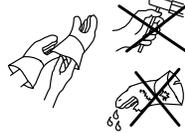
Use guantes aislantes secos y sin orificios y protección corporal. No toque el electrodo con la mano descubierta. No use guantes húmedos ni dañados.
