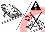
Protéjase de las descargas eléctricas; para ello, use aislamiento que lo separe del área de trabajo y del suelo. En lo posible, use material aislante seco, no inflamable o alfombras de goma, maderas o tablones secos, u otro material aislante seco lo suficientemente grande como para cubrir toda el área de contacto con el trabajo o el suelo y esté atento ante un incendio potencial.
