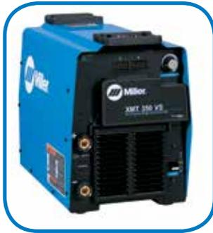
En algunos talleres, es preferible tener tanto fuentes de alimentación de CA como de CC disponibles. Las fuentes de alimentación para soldaduras de tipo rectificador con transformador pueden proporcionar tanto potencia de CA como de CC. El operador puede seleccionar fácilmente corriente alterna o continua a partir de este tipo de fuente de alimentación.
