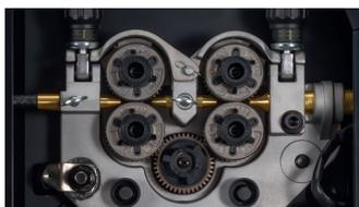
**Industrielles 4 Rollen-Drahtfördersystem aus Aluminiumguss mit Getriebeübersetzung.** Sorgt für außergewöhnliche Fördereigenschaften, bietet Verlässlichkeit und Drahtvorschubgeschwindigkeit im Bereich von 1.3 – 20 Meter pro Minute.
