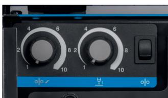
**Mit den Reglern für das Einschleichen und die Freibrennzeit können die Zünd- und Endparameter für den Lichtbogen optimal eingestellt und dadurch das Stoßen des Drahtes bzw. der Drahrückbrand verringert werden.**
