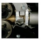
La languette de blocage de la torche fonctionne avec les torches équipées des rainures de blocage correspondantes pour empêcher la torche de sortir si elle tire sur le dévidoir.
