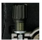
Le bouton de pression progressive du fil permet d'ajuster facilement et de maintenir une pression constante sur les galets d'entraînement et le fil.
