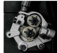
Sistema de dos rodillos de alimentación en aluminio para trabajo pesado.
