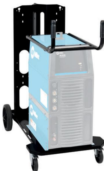
La máquina y el refrigerador se muestran con el carro universal y asas.
