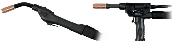
**Nur für MPa Plus-Drahtvorschubgeräte!** XR-Aluma-Pro™ Plus und XR™-Pistol Plus Push-Pull-Schweißbrenner zum Aluminiumschweißen. Lieferbar in Längen von 4,6 und 7,6 sowie 10,6 m, für einen weiten Arbeitsbereich und störungsfreie, kontinuierliche Drahtförderung. Schweißbrenner in luft- oder wassergekühlter Ausführung.
