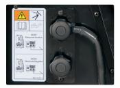
Leichter Zugang zu den Schweißkabelanschlüssen zum Wechsel der Schweißpolarität bei der Verwendung von Fülldrahtelektroden.
