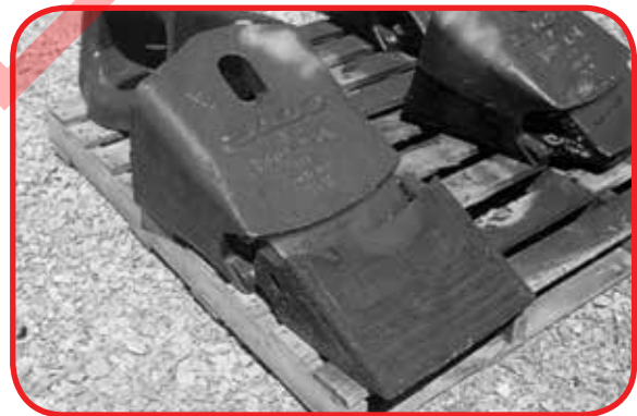
Figura 7 – RECUBRIMIENTO: reemplazo de diente de cuchara de excavadora de arrastre con recubrimiento duro como equipo nuevo.
