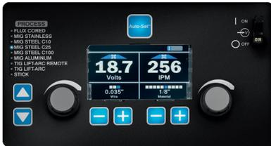
**Auto-Set™ Elite** offre des paramètres de soudure prédéfinis pour augmenter la facilité d'utilisation et s'assurer que le travail est fait correctement pour les opérateurs de tous les niveaux de compétence.
