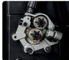
**Le système à deux rouleaux d'entraînement inclinés en aluminium robuste améliore** considérablement l'alimentation en fil à travers un pistolet de 15 pieds à partir d'une bobine de fil de 12 pouces.
