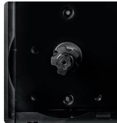
**Grand compartiment d'entraînement du fil pour loger une bobine de fil de 12 pouce** afin d'augmenter la productivité en réduisant la fréquence de remplacement des bobines de fil plus petites.
