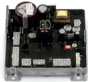
La placa de circuitos impresos encapsulada y en bandeja agrega una confiabilidad excepcional, incluso en los entornos más exigentes. La placa tiene un aislamiento pleno para el gatillo. Un gatillo de la antorcha en corto no afectará la operación del alimentador.
