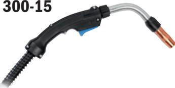
Se recomienda para soldaduras de primera pasada, en particular en aplicaciones de posición fija con visibilidad difícil. Incluye un cable de 15 ft (4,6 m), una punta cónica y una boquilla. Clasificación nominal de NEMA a 350 A a un ciclo de trabajo del 100 por ciento con gas CO<sub>2</sub>. Pase a una punta y boquilla estándar para soldadura de relleno y tapado con procesos de soldadura de núcleo fundente o MIG pulsada. Esto permite llevar a cabo la soldadura con un gas y un alambre.
